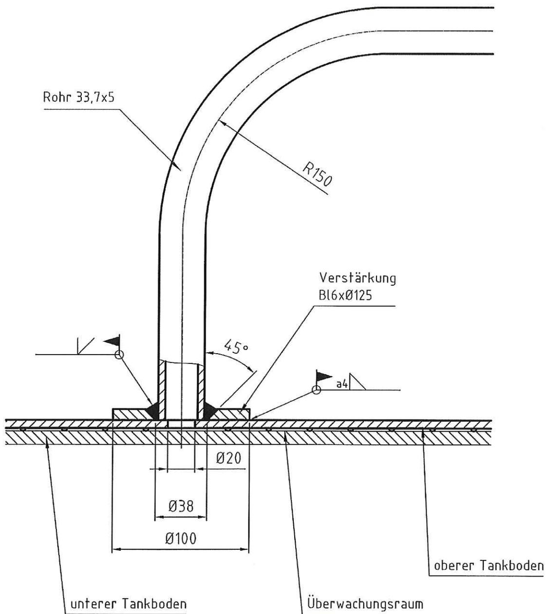
Leckschutzauskleidung aus Stahl Typ DBL-G und Typ DBL-T für Flachbodentanks nach
