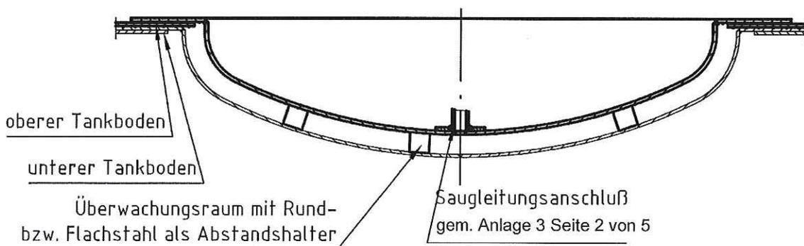
Leckschutzauskleidung aus Stahl Typ DBL-G und Typ DBL-T für Flachbodentanks nach
