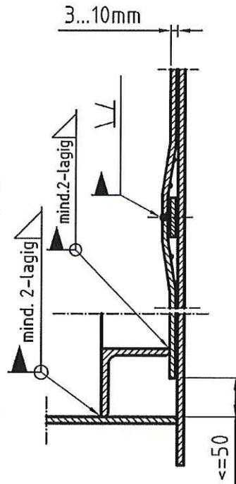
Leckschutzauskleidung aus Stahl Typ DBL-G und Typ DBL-T für Flachbodentanks nach DIN 4119
