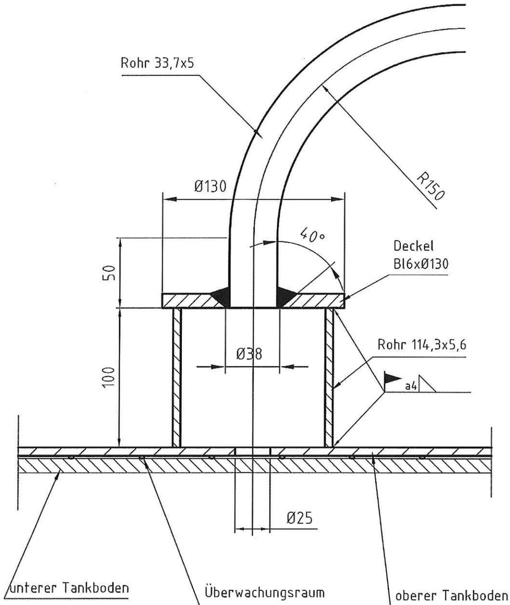
Leckschutzauskleidung aus Stahl Typ DBL-G und Typ DBL-T für Flachbodentanks nach
