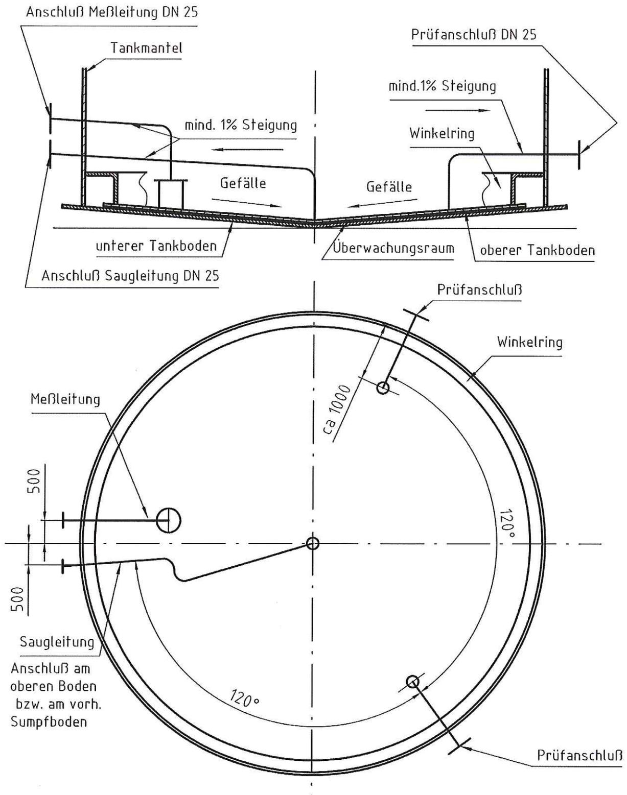
Leckschutzauskleidung aus Stahl Typ DBL-G und Typ DBL-T für Flachbodentanks nach DIN 4119
